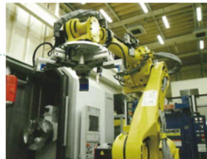
▲ロボットと組み合わされた複合加工機
